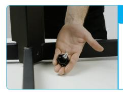
SCREW THE INCLUDED BRAKE KNOB INTO THE BOTTOM OF THE TABLE BASE.
